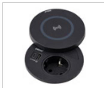
Steckdose schwarz, USB-Charger Typ A+C, max 2,1 A, 5V, Drehdeckel mit wireless charging
